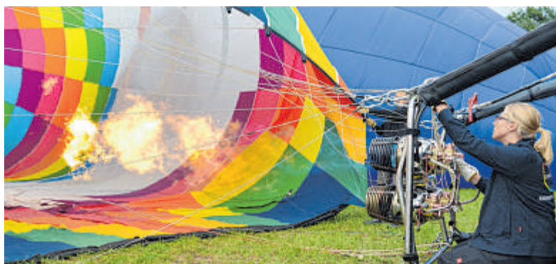
Damit die Hülle ihr Startvolumen erreicht, ist das sogenannte Anblasen angesagt. Pilotin Elise Kloss gibt Gas, langsam füllt sich die Hülle mit heißer Luft.
